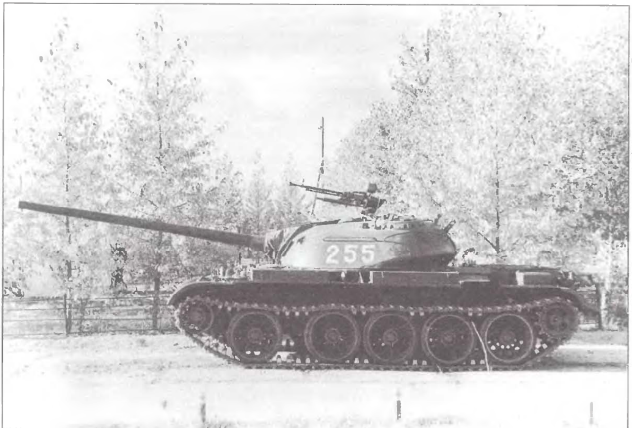
Средний танк Т-54-2. Хорошо видна башня характерной формы с обратным скосом в кормовой части
