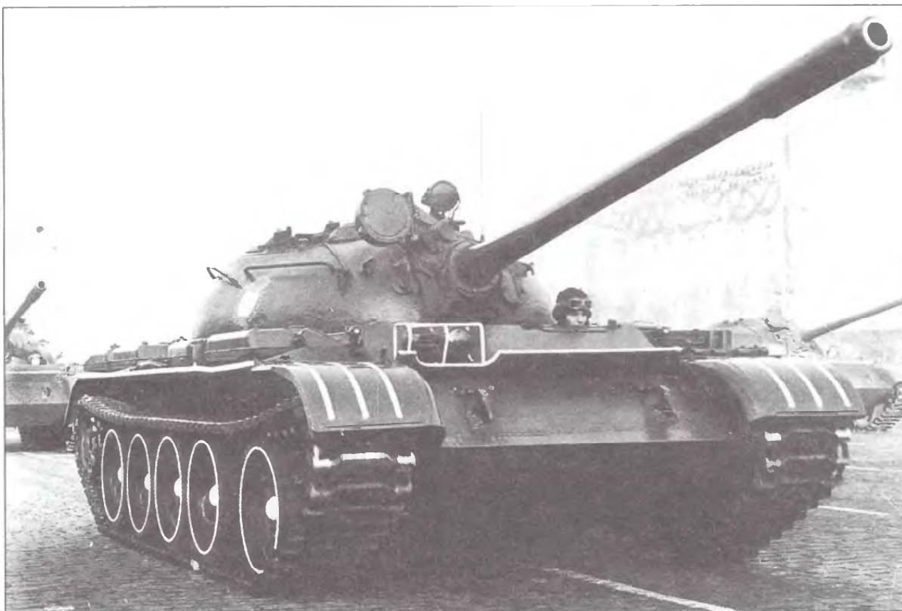
Средний танк Т-54Б. Москва, 7 ноября 1962 года. Обращает на себя внимание расположение ИК-прожектора Л-2 на орудийной маске
