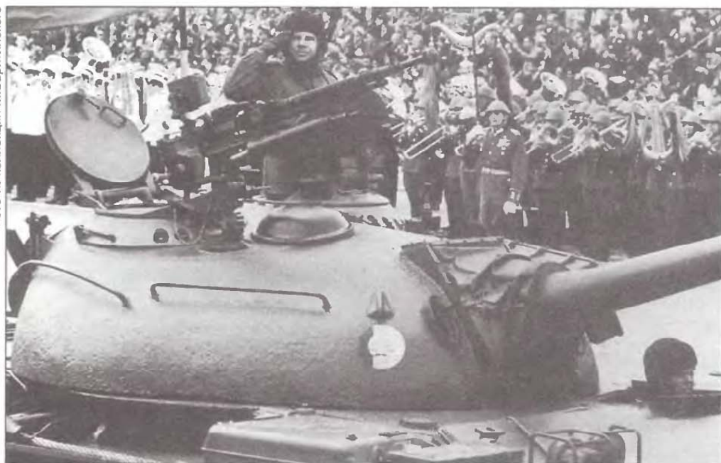
Башня танка Т-54А польского производства. Обращает на себя внимание колпак вентилятора позднего образца
